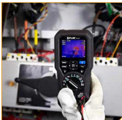
Obraz termiczny tablicy rozdzielczej
