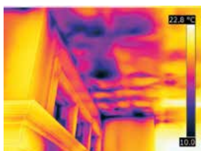
Szybkie wykrywanie zawilgoczeń i wad budynków
